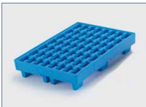
RR2 906 - Opvangpallet Opvangvolume: 35 lit. Ext. 1200 x 800 x 225 mm Statische draagkracht: 700 kg Gewicht 16 kg Kleur: groen of lichtblauw
