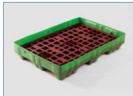
MXS 007 - Opvangpallet Opvangvolume: 150 lit. Ext. 1250 x 850 x 230 mm Dynamische draagkracht: 500 kg Gewicht 16 kg Kleur: groen, rooster bruin-rood
