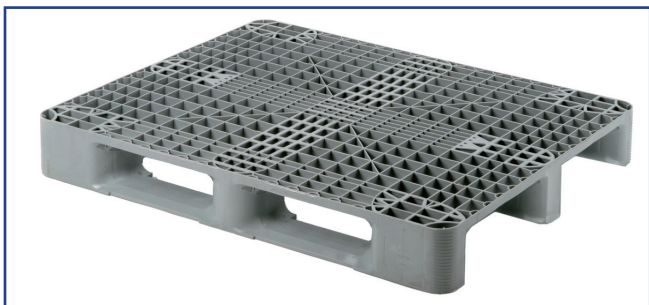
M-1208-MR3 - 1200 x 800 x 160 mm - 13,0 kg Dynamisch: 1250 kg - In rek: 500 kg
