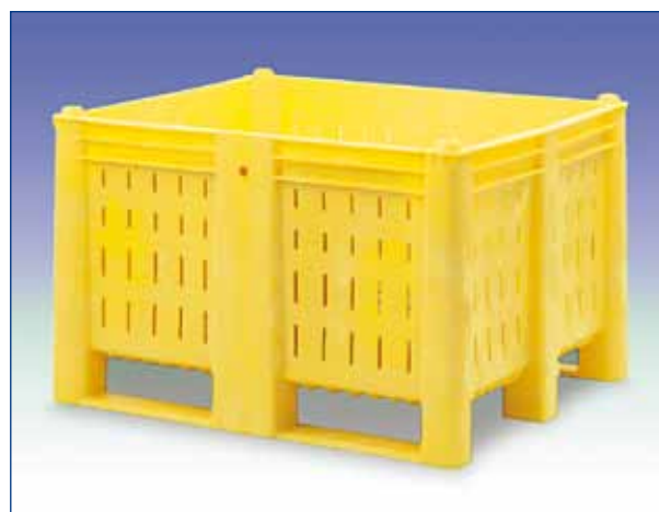
P-121001 - 600 Lit. - poids: 36,0 kg ext. 1200 x 1000 x 740 mm - int. 1120 x 920 x 600 mm P-121001/R - sur roues (hauteur totale: 960 mm) Coloris: jaune. Sur demande en brun ou bleu P-1210 - couvercle - Coloris: blanc - poids: 3,8 kg
