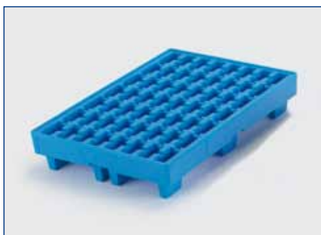
RR2 906 - Palette de rétention Volume de rétention: 35 lit. Ext. 1200 x 800 x 225 mm Charge dynamique: 700 kg Poids: 16 kg Coloris: vert ou bleu clair
