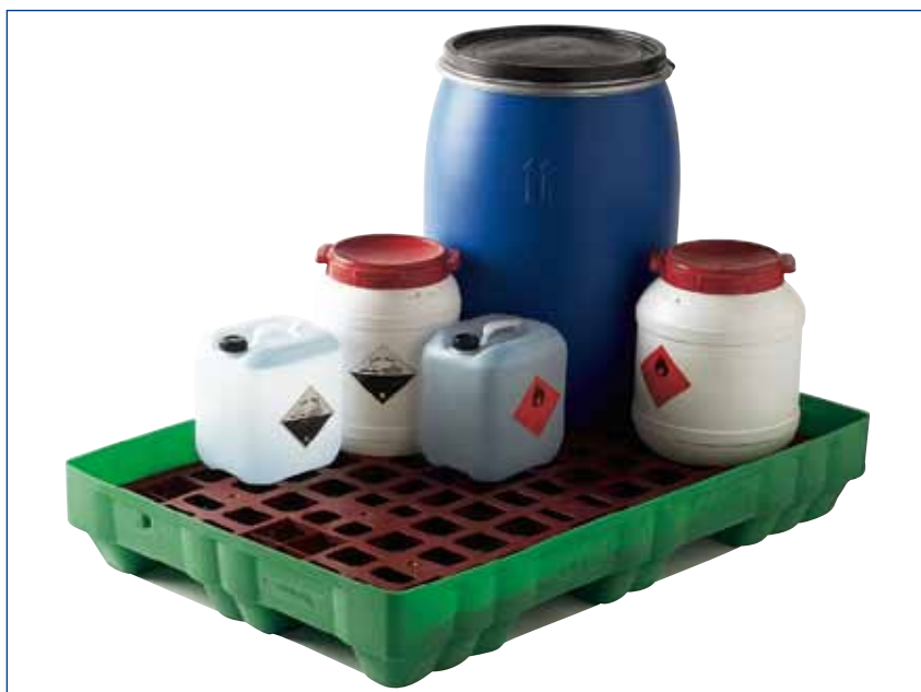
RR2 906 - Palette de rétention Volume de rétention: 35 lit. Ext. 1200 x 800 x 225 mm Charge dynamique: 700 kg Poids: 16 kg Coloris: vert ou bleu clair
